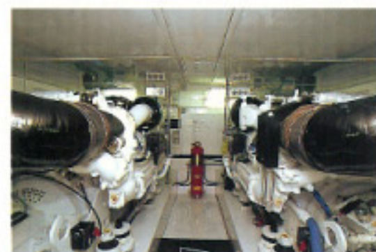
エンジンルームはそれほど広くはない。2基のDDC/M TU 8V2000 A90 900馬力ユニットとのマッチングは最高だ。
