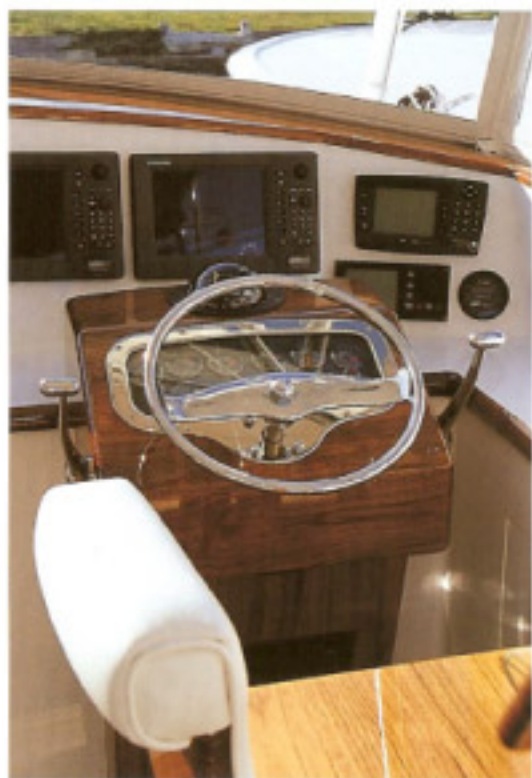
スターボードに寄せられたヘルムステーション。チークのヘルムボットとバームビーチスタイルのシングルアクションレバーが用意される。メインパネルにはフルノNavNetが納まる。
