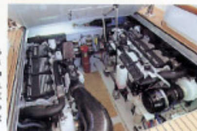
サロン下に納められたCAT18。メンテナンス性は申し分ない。2,744Lの燃料タンクはバルクヘッドをかわしてアフトの荷役に置かれる。
